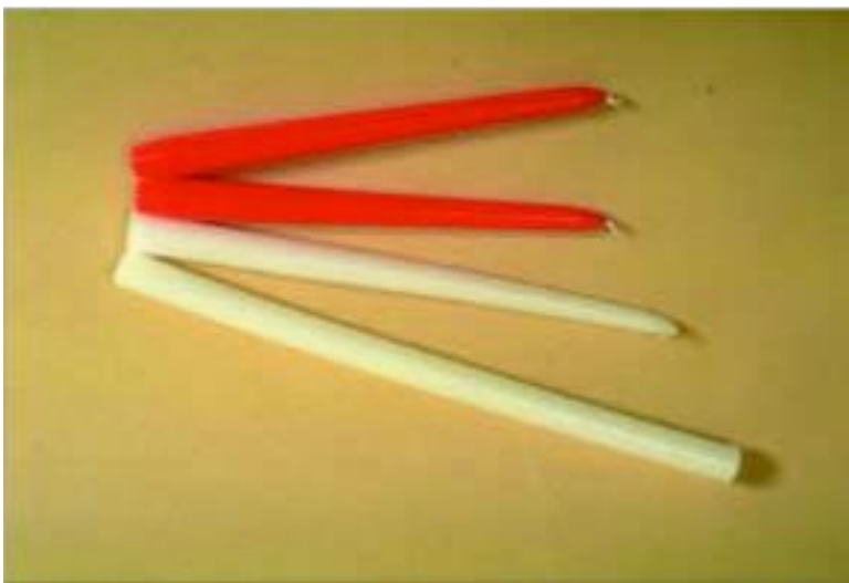
Figuur 5.11 Langwerpige kaarsen kunnen ook worden geperst. Ze hebben een gladder oppervlak en worden aan de boven- en onderkant bijgeslepen
