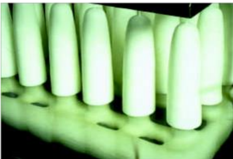
Figuur 5.8 Als de gewenste dikte is bereikt, wordt het overtollige kaarsvet afgesmolten om de kaars los te kunnen snijden
