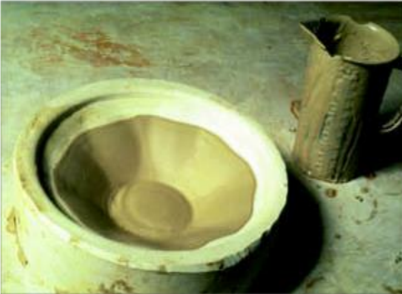
Figuur 4.15 Na enkele uren heeft het gips vocht onttrokken aan de klei. De mal wordt leeggegoten en er blijft een dunne wand achter
