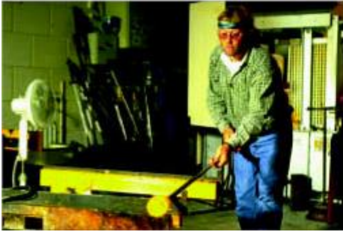
Figuur 4.23 Door voortdurend te draaien wordt de glasmassa in bedwang gehouden. Het is een continu gevecht tussen de zwaartekracht en de centrifugaalkracht
