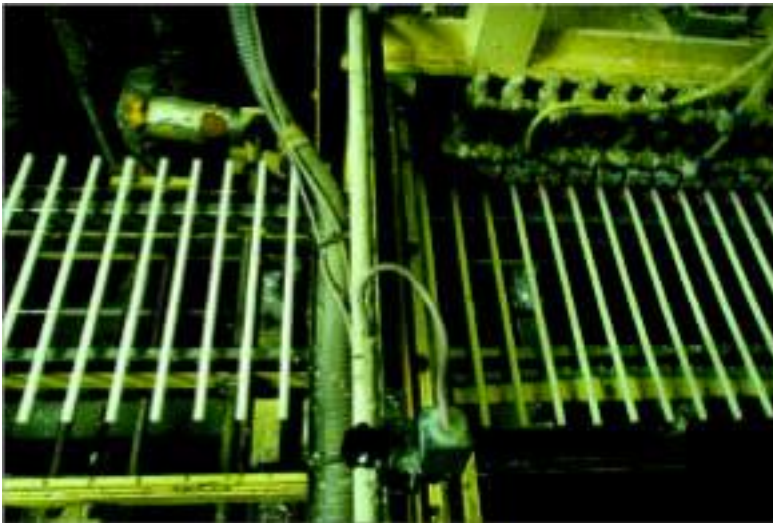
Figuur 5.14 De kaarsen worden bijgeslepen
