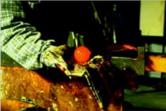
Figuur 4.20 Met behulp van een blaaspijp wordt een hoeveelheid glas (1180 °C) uit de oven gehaald. Men noemt dit een 'post'
