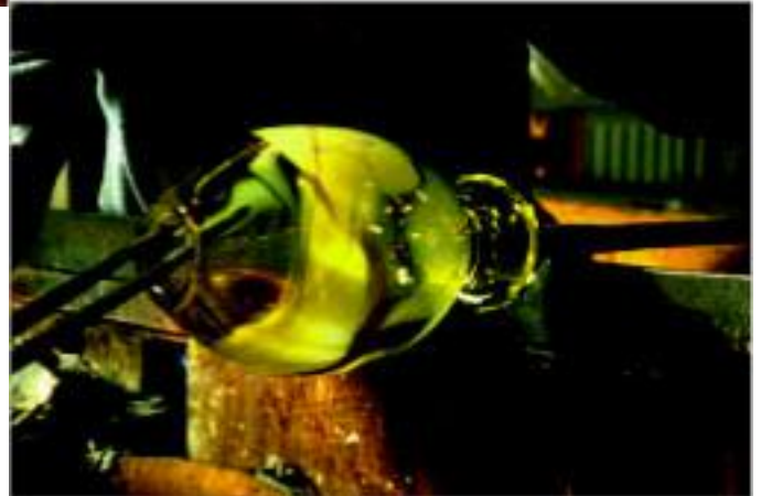
Figuur 4.32 De hals van de vaas wordt op de gewenste wijde gebracht (het ruimer maken van de hals)
