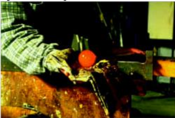
Figuur 4.25 Er is een nieuwe glaslaag aangebracht. De kleur zit nu in het glas. Met een natte krant wordt de glasmassa verder gevormd
