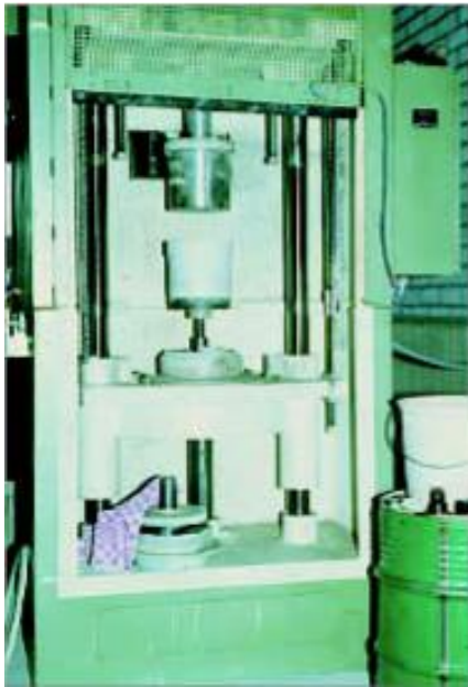
Figuur 4.17 Persen kan alleen als de contramal er nog uit kan
