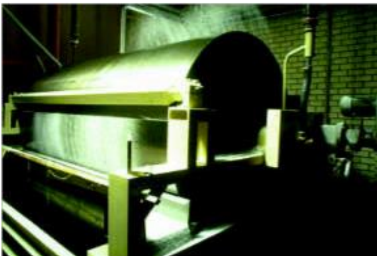
Figuur 5.12 Grondstof voor geperste kaarsen is paraffinepoeder. Vloeibare paraffine wordt verspoten en stolt op de metalen trommel. Het stolsel wordt afgevoerd.
