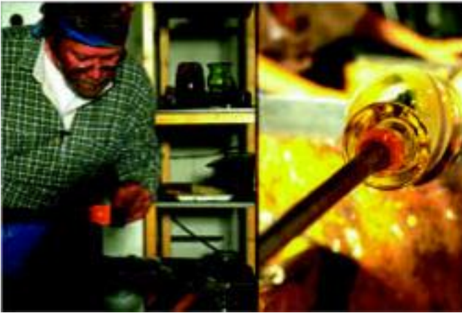
Figuur 4.31 Uit de oven wordt met behulp van een blaaspijp een 'hulpstuk' gehaald. Dit hulpstuk noemen we de 'pontil'. Deze wordt aan de voet van de vaas gesmolten. De blaaspijp aan de hals van de vaas wordt nu afgetikt
