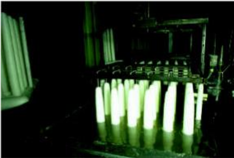
Figuur 5.7 Per dompeling, in de vloeibare paraffine van 80 °C, groeit de kaars 1mm dikte
