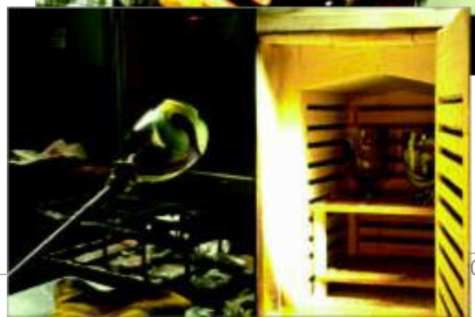
Figuur 4.35 a) De vaas wordt van de blaaspijp afgetikt. Het breekpunt blijft wat ruw en is het 'pontilmerk'; b) Binnen 35 seconden moet de vaas in een afkoeeloven van 535 °C worden gezet. Na
