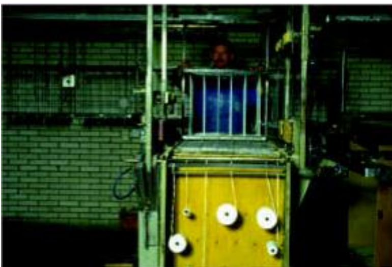
Figuur 5.5 Katoenen lonten worden op een rek gespannen
