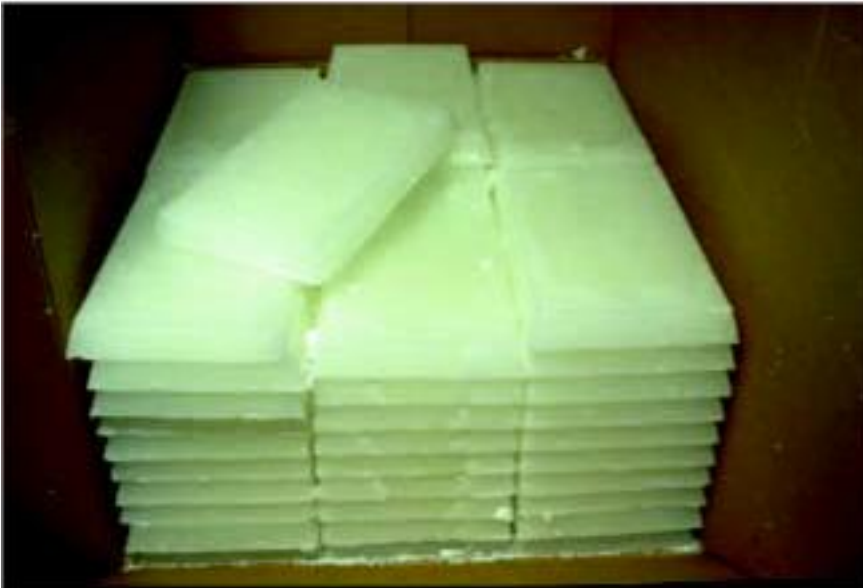
Figuur 5.3 Paraffine is een grondstof voor kaarsen en wordt in platen aangevoerd
