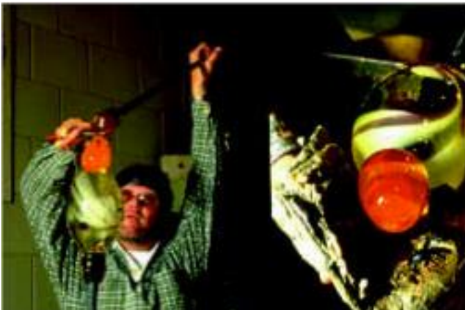
Figuur 4.29 a) Snel wordt de voet op de vaas 'geknipt'; b) Met een natte krant wordt de voet verder gevormd
